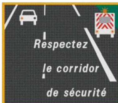
Indissociables et espacés de 300 mètres, ces trois panneaux de signalisation sont placés sur des tronçons autoroutiers afin de sensibiliser les usagers à respecter la règle du corridor de sécurité. La série de panneaux est déclinée dans une variante avec un poids lourd arrêté sur la bande d'arrêt d'urgence.
