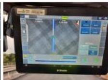
▲ Tablette de pilotage machine GNSS/RTK.
